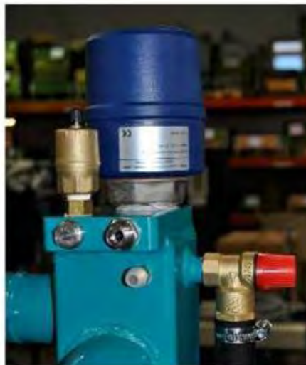
Abb. 31: Einschraubheizkörper zur Temperierung des Motorkühlkreislaufes auf 60 °C (Quelle: Schnell Motoren AG)
